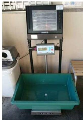
●竹ノ塚駅近くの中規模のスーパーマーケット。店舗裏口、商品納品口スペースの脇に設置。ダンボールは計量せず、台秤タイプを選定。ごみ置き場へ向かう前に計量するオペレーション。
