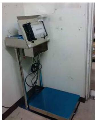
●都心部のミニスーパー。店舗バックスペースに設置。ダンボールは少量のため、台秤タイプを選定。ごみ置き場は外にあるため、ごみを一旦バックスペースで計量するオペレーション。
