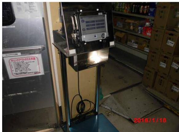
●都心部のミニスーパー。店舗バックスペースに設置。ダンボールは少量のため、台秤タイプを選定。ごみ置き場は外にあるため、ごみを一旦バックスペースで計量するオペレーション。
