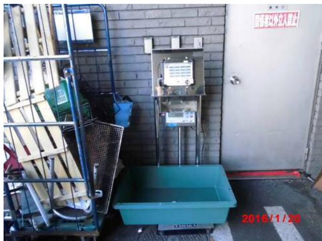
●東久留米駅近くの中規模のスーパーマーケット。店舗裏口、休憩場所横に設置。ダンボールは計量せず、台秤タイプを選定。ごみ置き場へ向かう前に計量するオペレーション。
