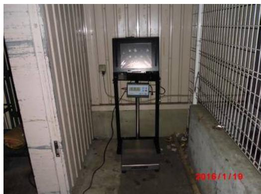
●多摩地区の大規模のスーパーマーケット。ごみ置き場の脇に設置。ダンボールは計量せず、台秤タイプを選定。ごみ置き場前を通過して計量するオペレーション。
