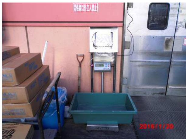
●東久留米駅近くの中規模のスーパーマーケット。店舗裏口に設置。店舗作業所とごみ置き場の間に設置。ダンボールは計量せず、台秤タイプを選定。ごみ置き場へ向かう前に計量するオペレーション。
